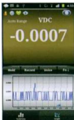
После нажатия кнопки
