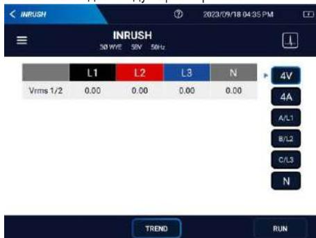
3. Подключение к сети типа 3QWYE — режим формы сигнала пускового тока:
