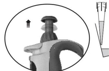
3. При продувке наконечник полностью опустошается: нажмите операционную кнопку до второго упора.
