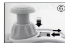
3. Полностью отодвиньте красный блокиратор назад, поднимите колёсико регулировки объёма и отпустите калибровочный предохранитель.
