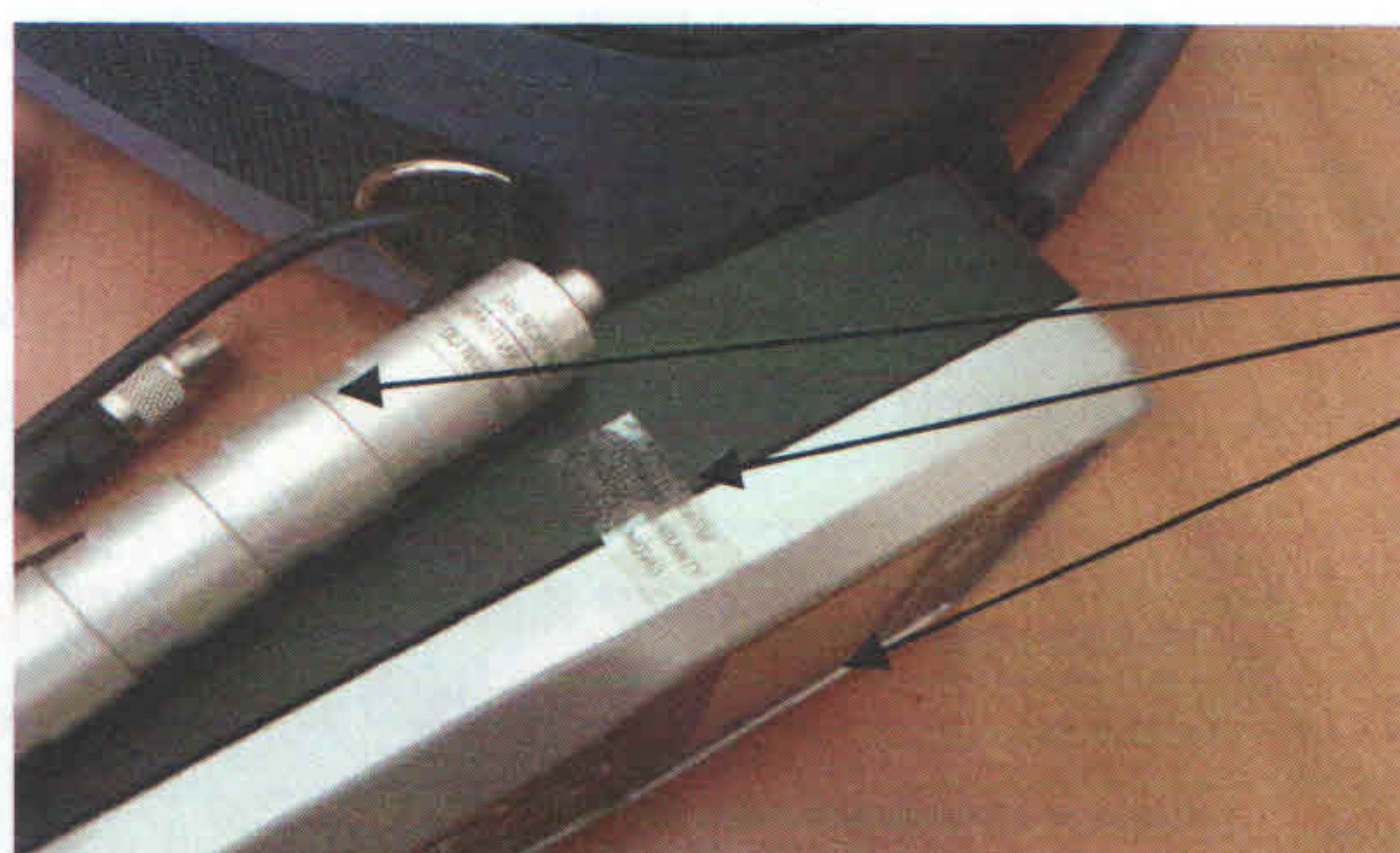
Рисунок 4 - Схема пломбировки твердомера.
