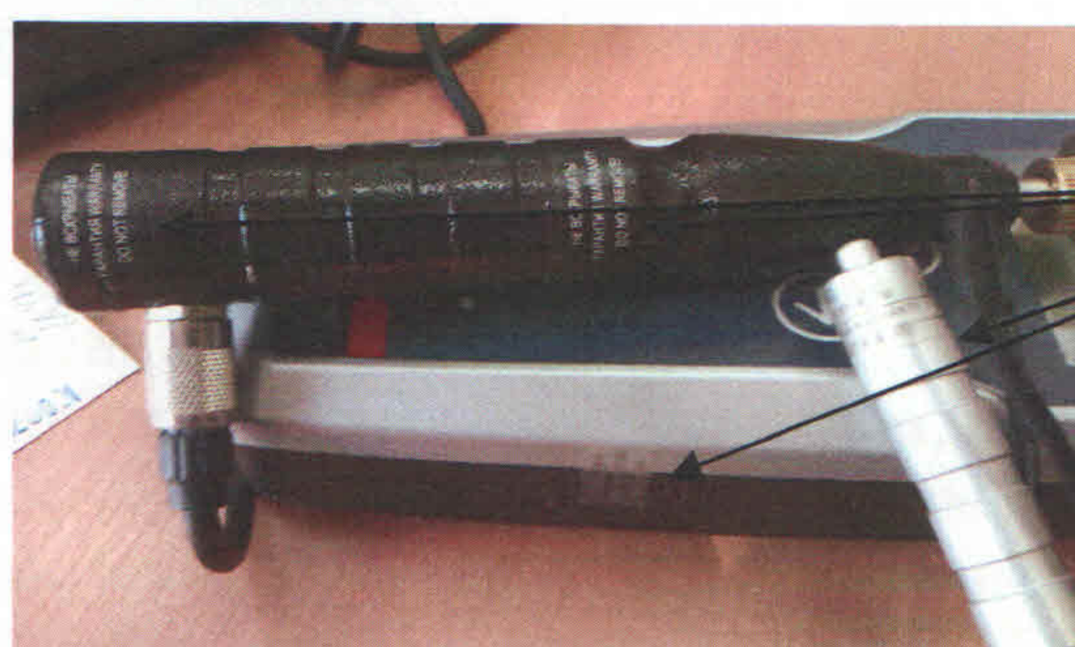
Рисунок 4 - Схема пломбировки твердомера.
