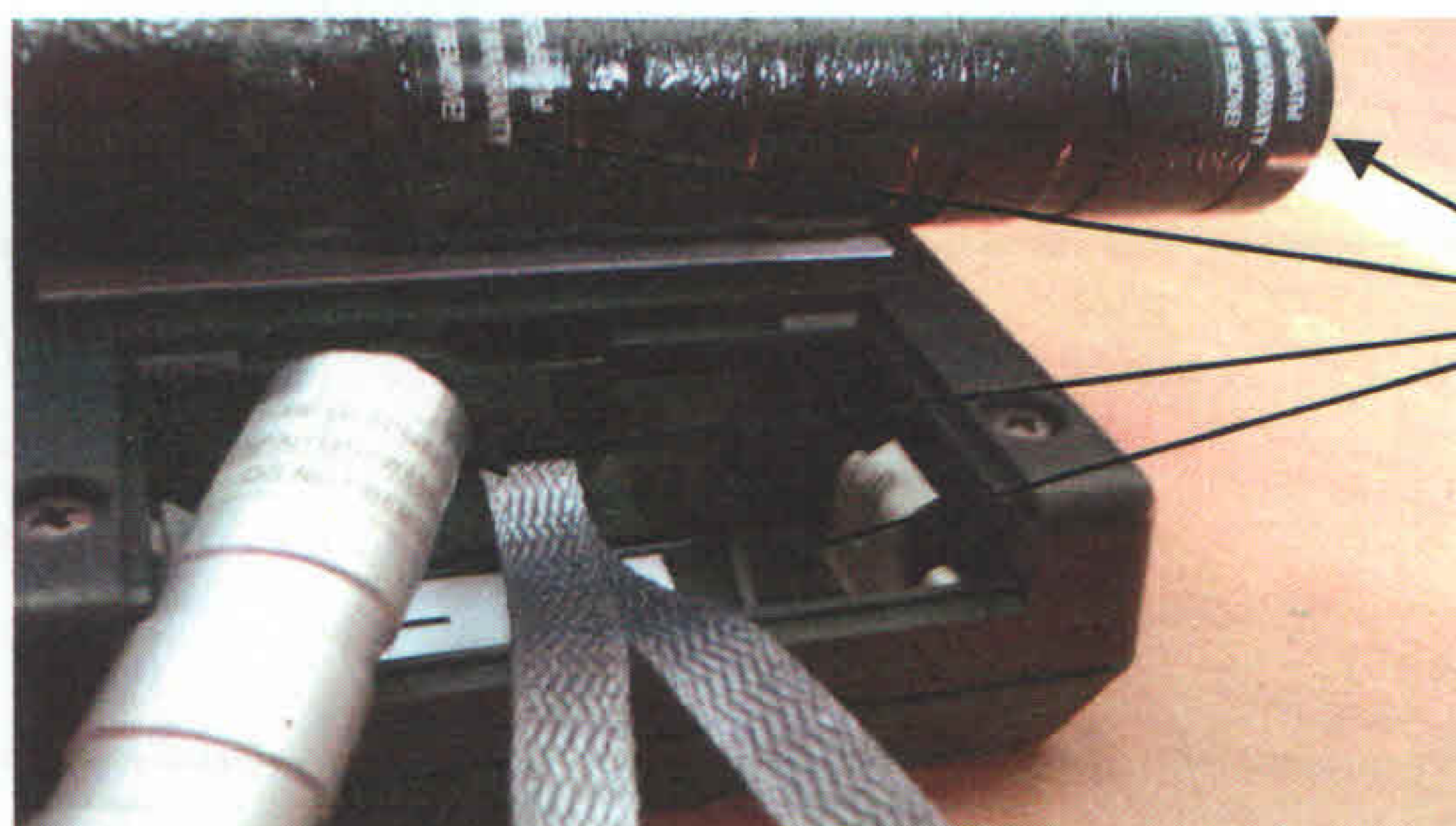
Рисунок 2 - Схема пломбировки твердомера.
