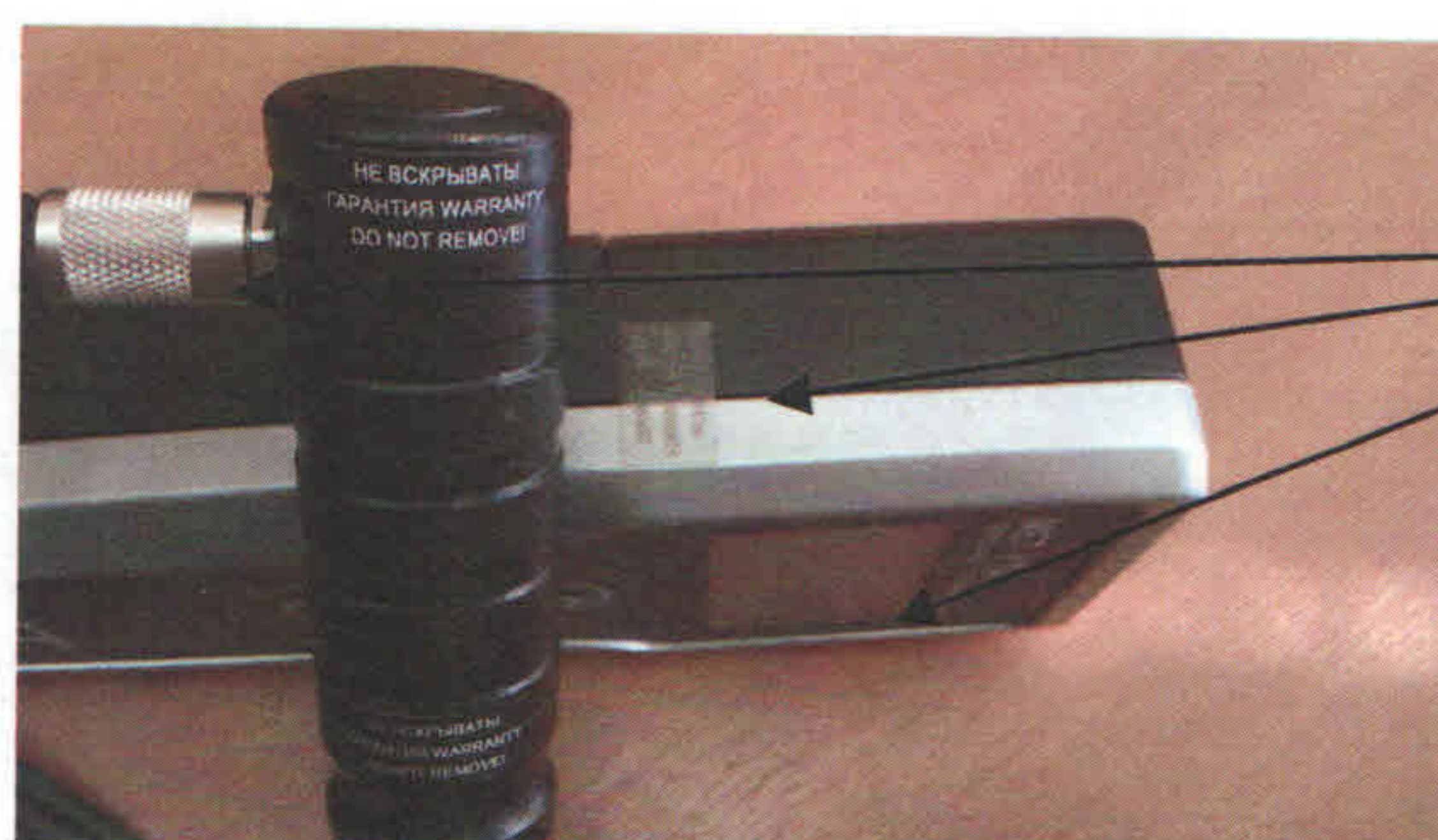
Рисунок 4 - Схема пломбировки твердомера.
