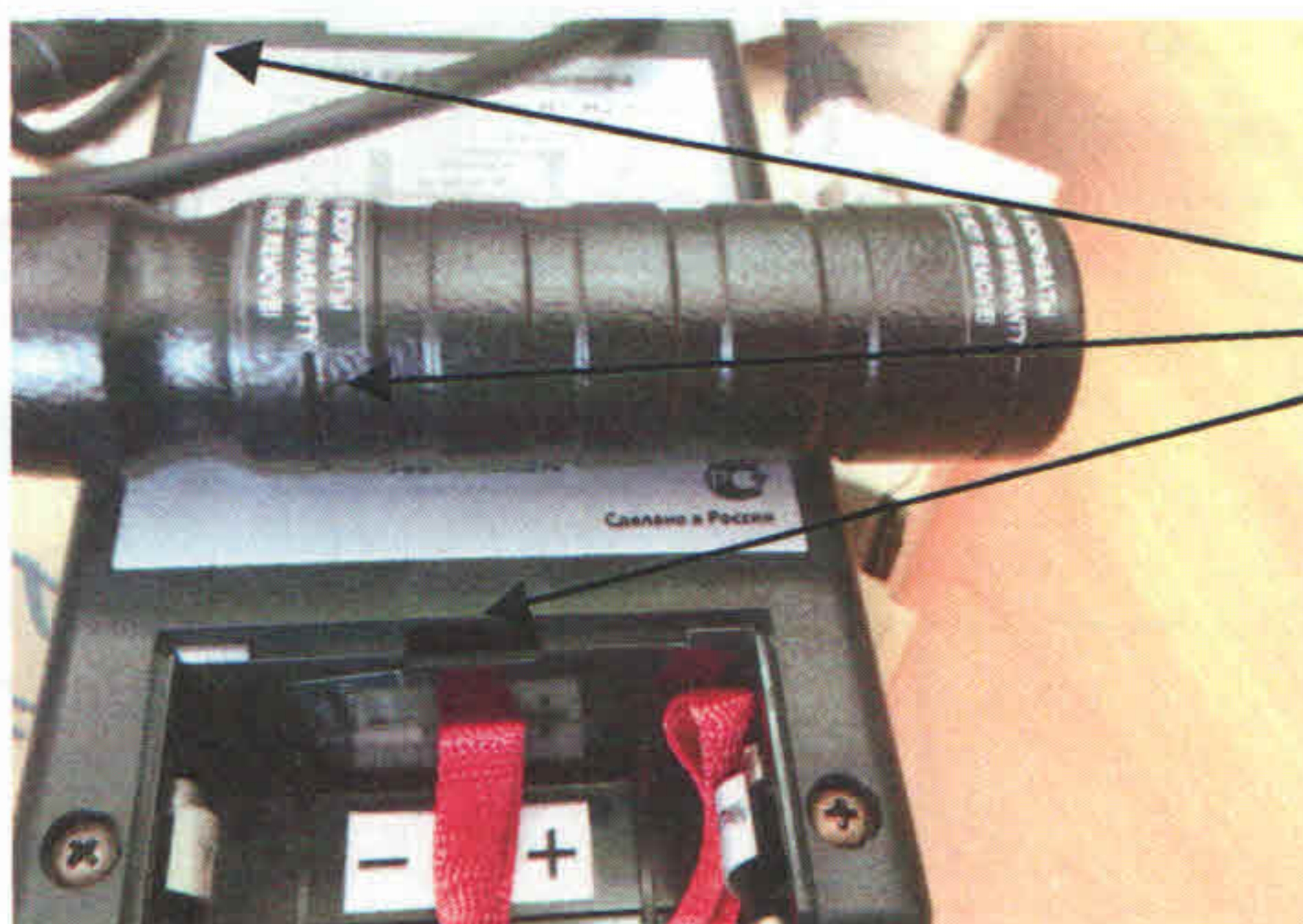
Рисунок 2 - Схема пломбировки твердомера.
