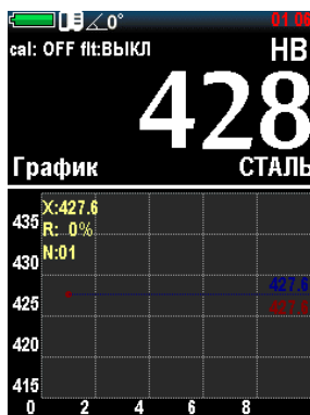
Рисунок 2.18 – Дисплей после замера динамическим датчиком
