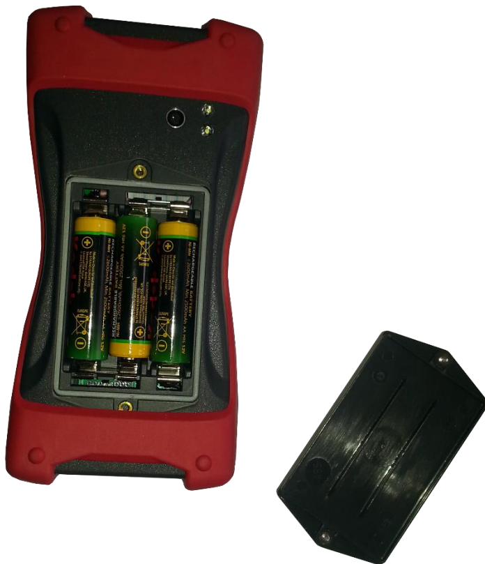
Рисунок 2.1 – Установка элементов питания
