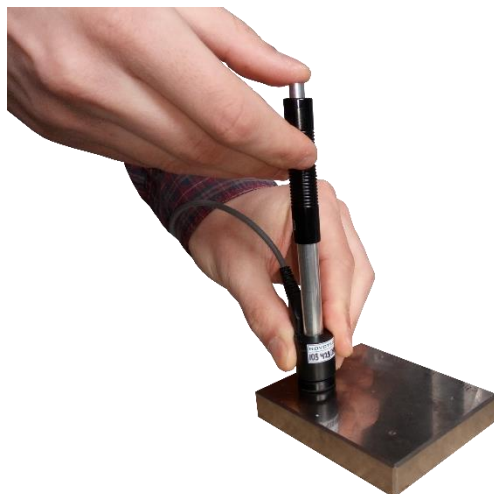
Рисунок 2.17 – Нажатие спусковой кнопки датчика
