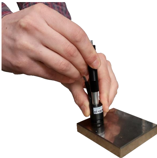
Рисунок 2.16 – Взвод пружины датчика
