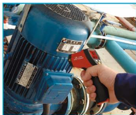
Отношение расстояния к размеру изображения D:S=12:1
