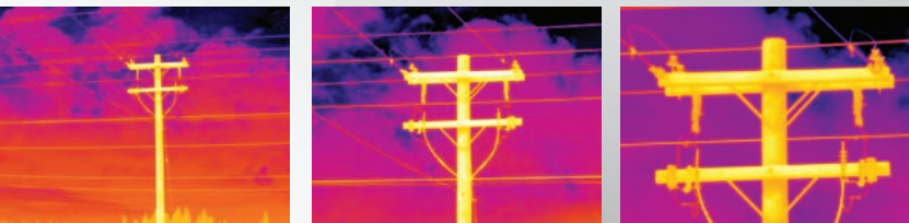
Стандартный объектив (слева), телеобъектив 2х (по центру) и телеобъектив 4х (справа) — посмотрите на правильное ИК-изображение критически важных деталей
