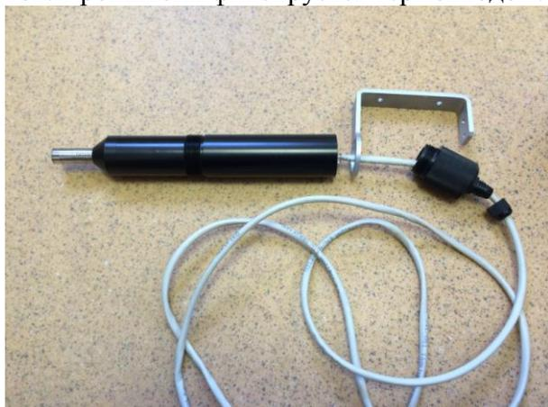
Рис.3д. Устройство с открученным гермовводом
