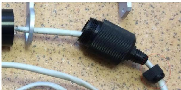
Рис.3ж. Ослабленный кабельный зажим гермоввода
