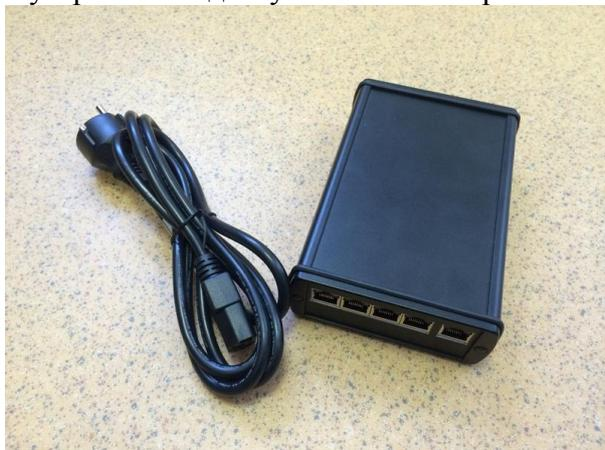
Устройство POW-ETH-05 имеет пять соединительных разъемов для подключения кабелей «витая пара».
