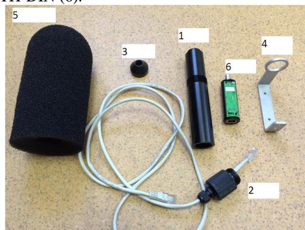
Рис.3б. Составные части EPS-ETH-04
