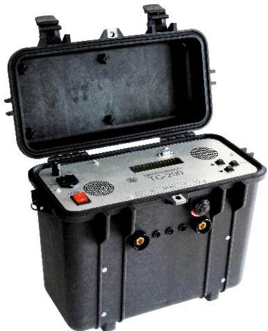
Микроомметр ТС-200 предназначен для измерения переходного электрического сопротивления соединителей цепей энергосистем: контактов воздушных, масляных и др. выключателей, болтовых, паяных и других соединений в условиях помех электрического поля с напряженностью до 30 кВ/м (подстанций до 750 кВ).
