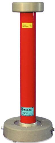
Делитель напряжений высоковольтный ДНВ-80А предназначен для преобразования уровня амплитуды напряжения постоянного (до 80 кВ) тока и переменного (до 60 кВ) тока до уровня, безопасного для последующей обработки, хранения, передачи или дальнейших преобразований измерительного сигнала.
