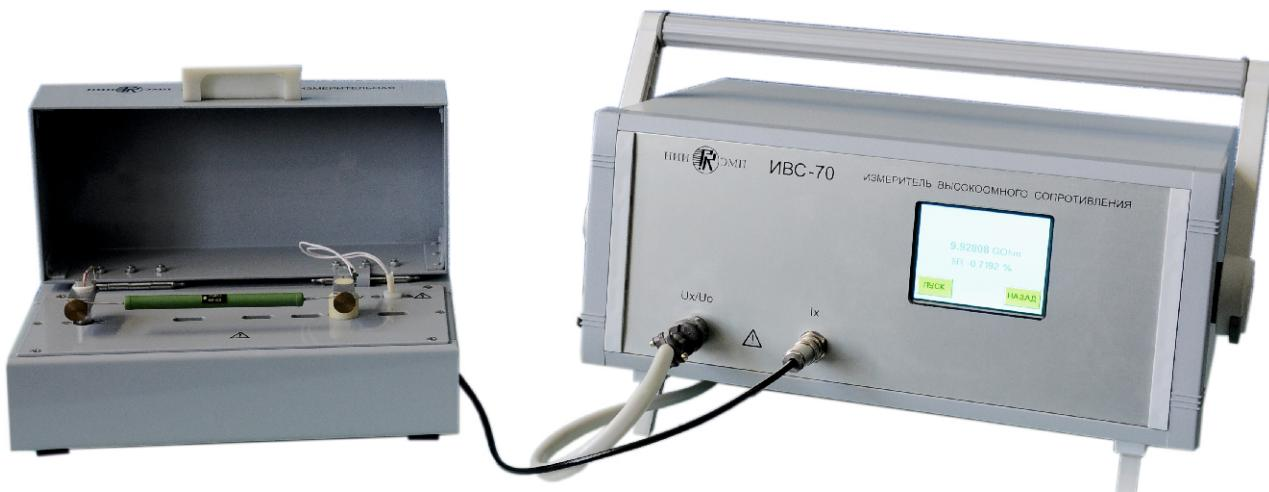
В конструкции прибора применены материалы, обеспечивающие возможность измерения сопротивления порядка петаом (ПОм). Прибор имеет простое и удобное управление вследствие применения сенсорного экрана, служащего также для отображения результатов измерений.
