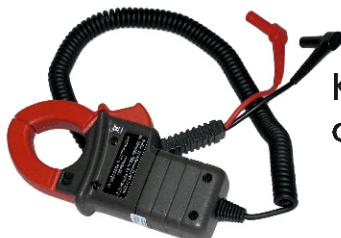
Каждый конкретный прибор калибруется с конкретным датчиком тока 100А (токовые клещи).
