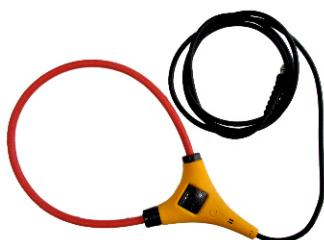
Конкретный прибор калибруется тремя конкретными датчиками тока 2000А (катушка Роговского).
