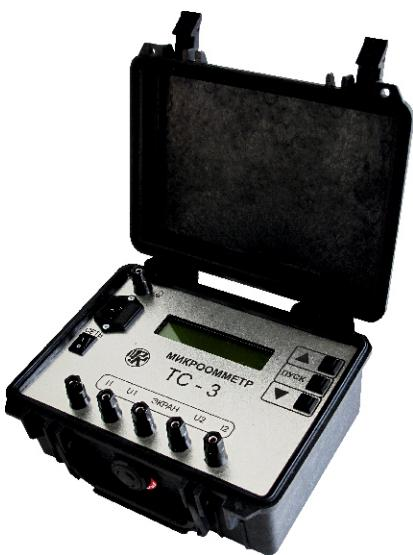
Микроомметр ТС-3 предназначен для измерения переходного электрического сопротивления соединителей цепей энергосистем: контактов воздушных, масляных и др. выключателей, болтовых, паяных и других соединений в условиях помех электрического поля с напряженностью до 30 кВ/м (подстанций до 750 кВ). Прибор и его предшествующие модели (ММО-1, БСЗ-010 и др.) около двадцати лет успешно эксплуатируются предприятиями ТЭК России, Белоруссии, Украины и Казахстана.
