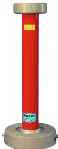
Делитель напряжений высоковольтный импульсный ДНВ-80И предназначен для преобразования уровня амплитуды напряжения постоянного (до 80 кВ) тока, переменного (до 60 кВ) тока и импульсного (до 160 кВ) тока до уровня, безопасного для последующей обработки, хранения, передачи или дальнейших преобразований измерительного сигнала.
