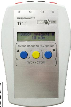
Компактный прибор предназначен для измерения электрического сопротивления постоянному току различных узлов распределительных щитов, небольших подстанций, электрических аппаратов и др., в том числе контактов выключателей, болтовых, паяных и других соединений цепей энергосистем в условиях помех электрического поля с напряженностью до 20 кВ/м.
