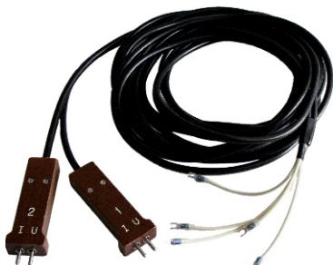
По дополнительному заказу потребителю поставляется входной измерительный кабель с контакторами, обеспечивающими четырёхзажимное подключение к объекту контроля. Заточенные наконечники контакторов позволяют добиваться надежного контактирования с объектом, поверхность которого покрыта краской или плёнкой окислов. Длина измерительного кабеля выбирается из ряда: 3, 5, 10 и 15 метров.
