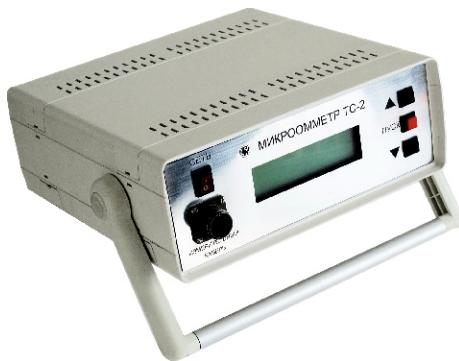
Микроомметр ТС-2 предназначен для измерения малых значений электрического сопротивления в лабораторных условиях. Современный прибор имеет широкий диапазон измерений, малые габариты, прост в управлении и надежен в работе.
