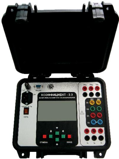
Прибор «Коэффициент-3.3» позволяет одновременно по трем фазам измерять для трансформаторов всех схем и групп соединения по ГОСТ 30830:
