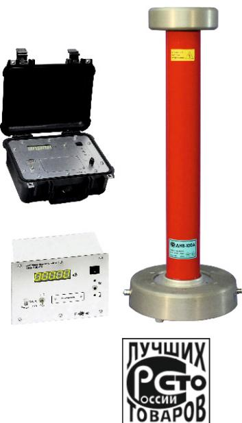
Цифровой киловольтметр СКВ-100 предназначен для измерений напряжений постоянного тока, действующих и амплитудных значений напряжений переменного тока. Прибор может применяться для поверки измерительных трансформаторов напряжения, контроля и измерения сигналов при производстве и учете электроэнергии.
