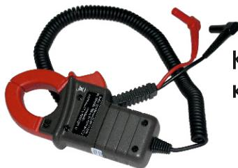
Каждый конкретный прибор калибруется с тремя конкретными датчиками тока 200А (токовые клещи).
