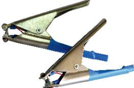
Контактор (вариант 1) представляет собой одну пару подпружиненных клемм длиной 150 мм и толщиной металла – 0,7 мм. Клеммы снабжены двумя заострёнными контактами в верхней части губок и одним – в нижней части губок. Два верхних контакта соединены с токовой, а один нижний – с потенциальной цепью входного кабеля. Контакты изолированы от клемм. Максимальное расстояние между потенциальным и токовыми штырями при раскрытии клемм составляет 20 мм.
